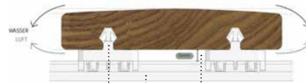
**NUTEN** auf der Unterseite sorgen für Entlastung der Dielen und sind speziell für den GRAD® Clip geeignet
